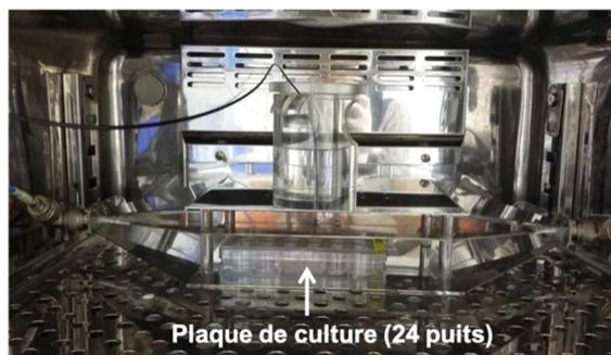
**Illustration 23 : Plaque de culture (24 puits) insérée dans un dispositif logé à l'intérieur d'une étuve de culture. L'alimentation électrique du dispositif permet une exposition calibrée des cellules microglialesensemencées dans les puits de culture à des signaux de type GSM 1800MHz (Crédits : Michel Mallat)**
